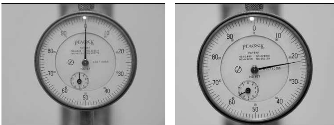
Figura 2 – A: Marcador analógico graduado (zerado); B: Marcador analógico graduado, após 30 segundos da remoção da carga compressiva.
